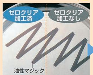
ステンレス製丸盆にゼロクリア加工済及び加工なし面を用意し、油性マジックで汚れをつけ、水をかけます。
