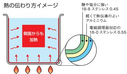
アルミの熱伝導率はステンレスの約13倍。鍋底で受けた熱をす
