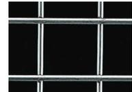
縦線・横線を直角に配列し、交点を特殊な電気抵抗溶接しています。網目は平坦で、折網と異なりほつれる事がなく、細い線径で大きな網目が可能です。
