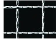
線材を歯車で均一な波形に加工し、縦・横線をはめ合わせて作った金網で、縦横線は互いに強固に組み合わされているため、網目は正しく保持されています。
