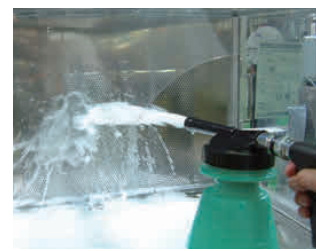
※ スプレヤーの噴射口から洗浄対象面までの適切な距離は50cmです。(水圧によっても変わります)
