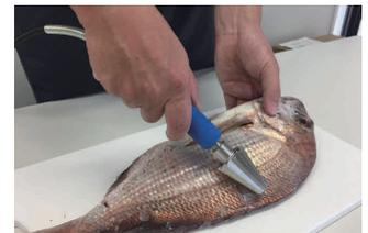
●10枚刃と傾斜刃の設定で細かい部分までウロコを除去できます。
