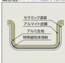
底面(裏面)に特殊磁性体を溶射、電磁調理器からガスコンロまで、全ての熱源に対応。表面にアルマイト加工を施すことによって、アルミ生地を保護し、鍋の内側が黒くなることを防ぎます。さらに、外表面にはセラミック塗装(焼付け塗装)が施されています。
