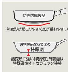
鋳造製フライパンは、鋳造された状態から自然硬化する過程で独特な結晶組織を形成。熱をたっぶり蓄え全面を均一に加熱し、加熱ムラの無い「特厚底」を特徴としています。底面が加熱される電磁調理器などのクッキングヒーターの熱源に対し、熱変形に強く長くお使いいただけます。
